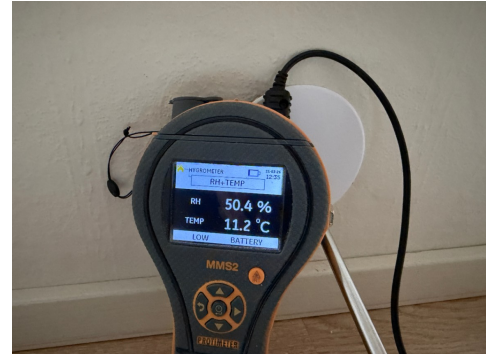
Måling av relativ luftfuktighet.
